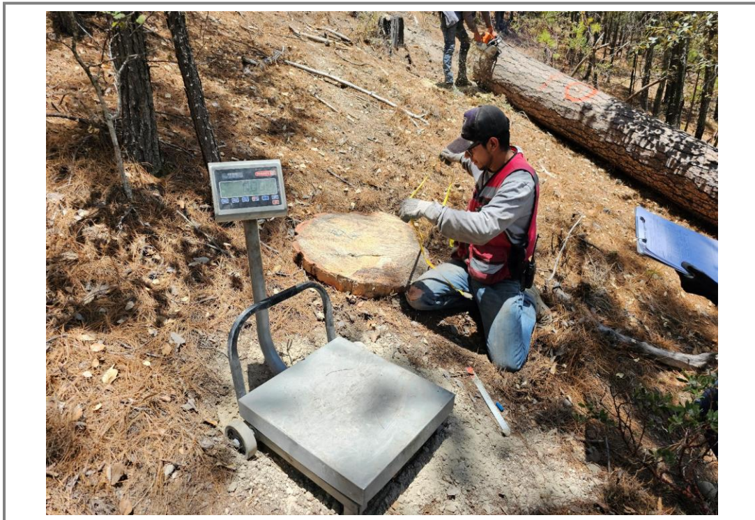
Figura 1. Muestreo de componentes de volumen para determinar la clasificación de productos maderables.
