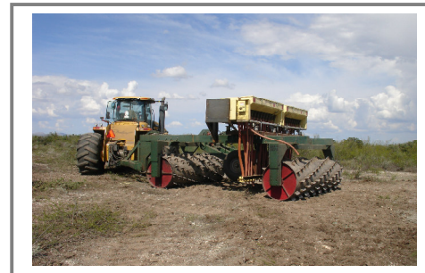
Rodillo con sembradora integrada y siembra de pastos con un solo paso de maquinaria.
