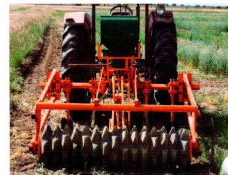
Sembradora INIFAP para simple, doble y triple hilera acoplada a un sistema de captación de agua *in situ*.
