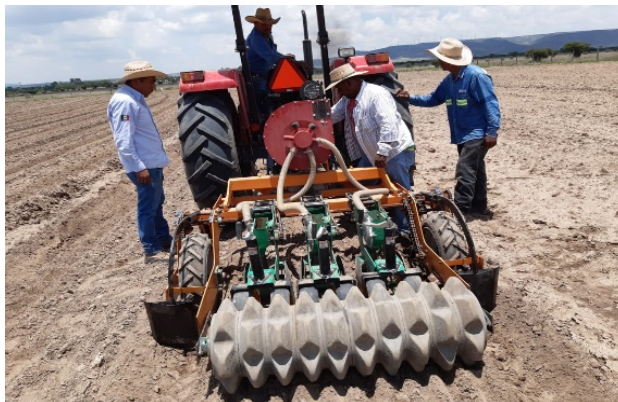
Sembradora neumática monograno (Multi 01) y siembra encamas a seis hileras con sistema de captación de agua in situ integral.
