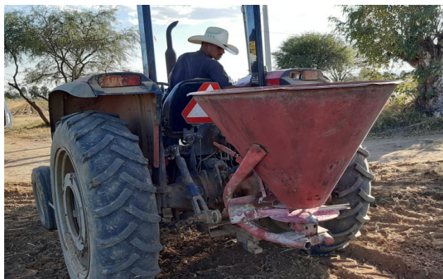
Sembradora: tipo centrífuga para siembra a voleo de cereales.
