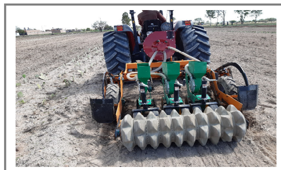
Sembradora neumática monograno (Multi 01) y siembra en camas a seis hileras con sistemas de captación de agua in situ integral
